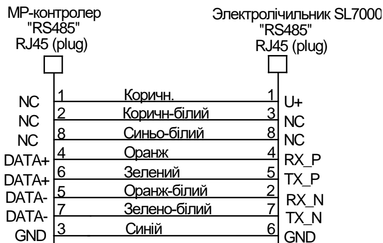
5.2.19. Схема кабелю для з'єднання «МР-SL7000» по інтерфейсу RS-485.
