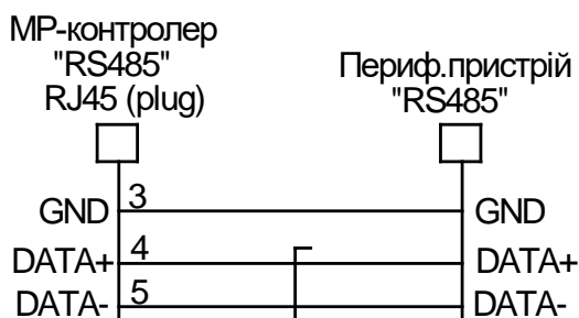
5.2.19. Схема кабелю для з'єднання «МР-SL7000» по інтерфейсу RS-485.
